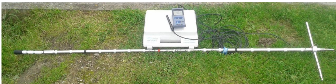
Figuur 1. Het gebruikte meetinstrument, de EGV-meter, met uitleeskastje en verlengstok om op meer diepte te meten.
