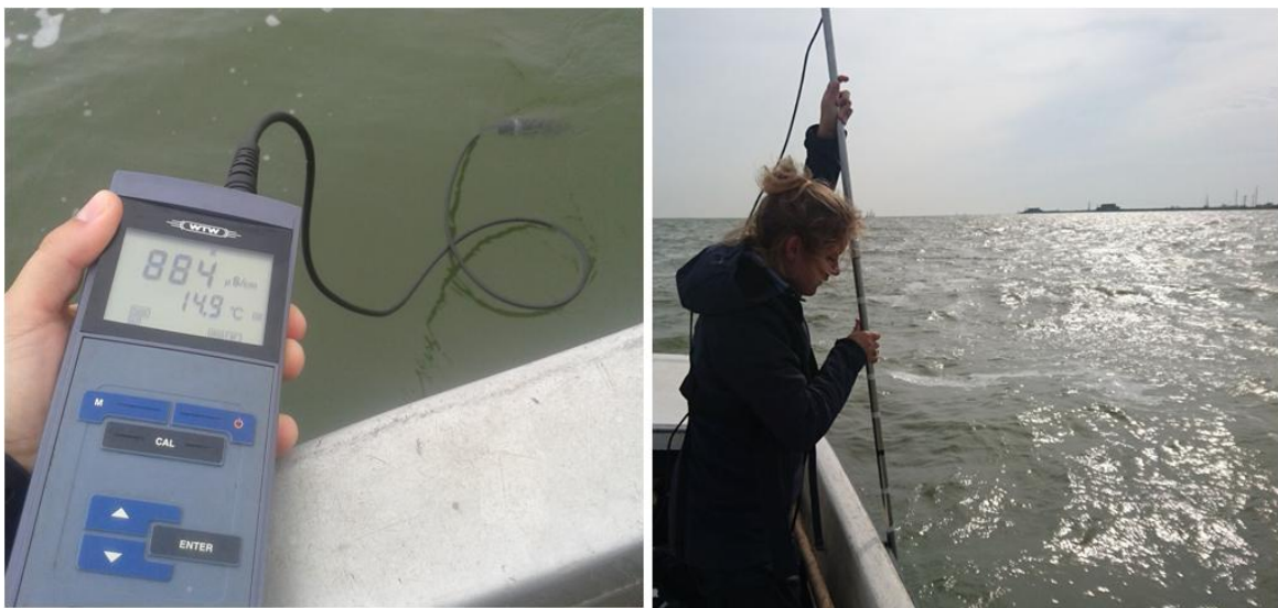
Figuur 2. Meting van het EGV aan het oppervlak met sensorsnoer (links) en op diepte gekoppeld aan een verlengstok (rechts).
