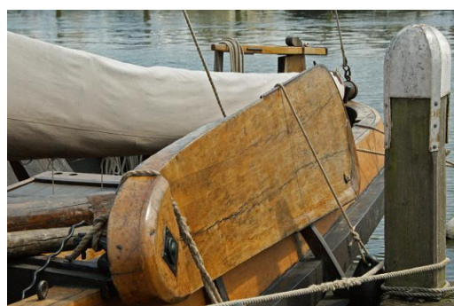
Afbeelding 6. Schets (links) en een voorbeeld van een zijwaard op een botter in Spakenburg
