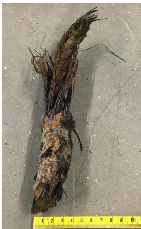
Afbeelding 8. Een stuk van de staalkabel op locatie 23.
